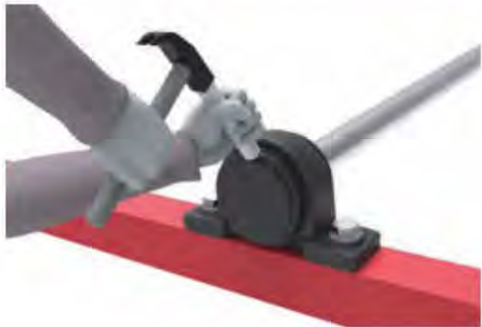
图 14.12 钢板盖的安装
