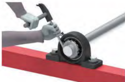
图 14.8 折弯垫圈的爪(锁紧螺母的防松)
