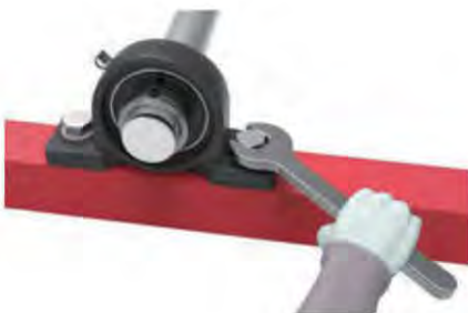
图 14.4 将连座滚动轴承固定在底座上
